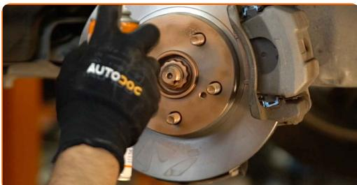
19 Puhastage piduriketta pind. Kasutage piduri puhastusvahendit.
