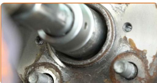
**18** Puhastage kinnitusdetail, mis ühendab kuulliigendit ja käändtelge. Kasutage terasharja. Kasutage WD-40 aerosooli.
