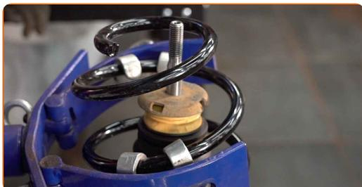
**35** Paigaldage ülemine vedrupüstak ja vedrupüstaku laager.
