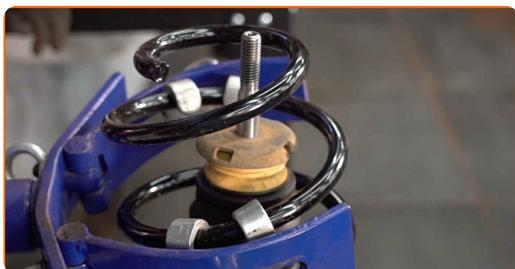
**33** Paigaldage ülemine vedrupüstak ja vedrupüstaku laager.
