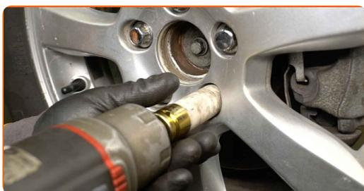
**27** Laske auto alla ja töödake risti järjekorras, pingutage rataste poldid. Kasutage ratta löökpadrunit #19. Kasutage momentvõtit. Pingutage seda 140 Nm pöördemomendiga.
