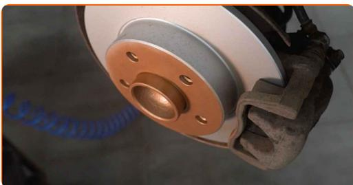
23 Puhastage piduriketta pind. Kasutage piduri puhastusvahendit.
