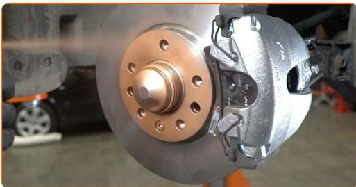
**54** Puhastage piduriketta pind. Kasutage piduri puhastusvahendit.
