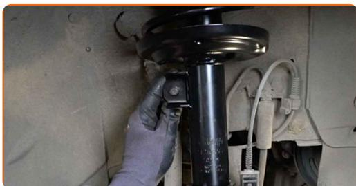
**50** Pingutage kinnitust, mis ühendab stabilisaatorilülid amordipüstakuga. Kasutage kombivõtit Nr. 17. Kasutage padrunit Nr.18. Kasutage momentvõtit. Pingutage seda 55 Nm pöördemomendiga.
