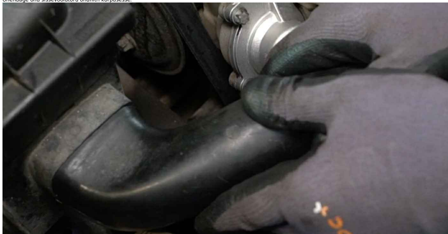
32 Paigaldage klamber õhufiltri õhuvõtuvoolikule.
