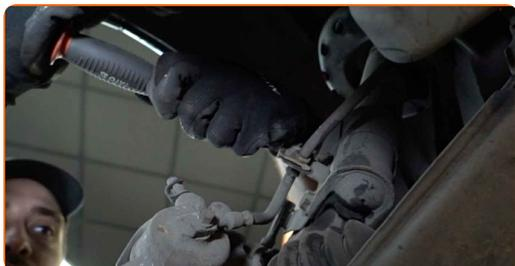
**28** Puhastage piduriketta pind. Kasutage piduri puhastusvahendit.
