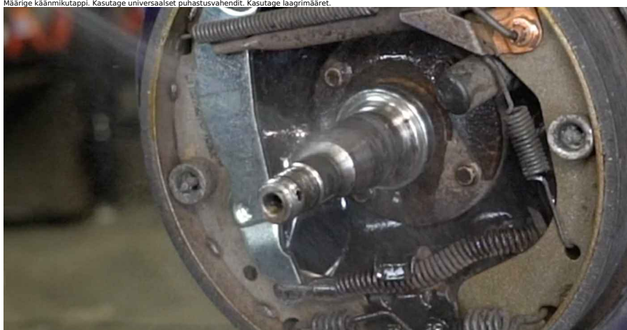
24 Paigaldage piduritrummel koos rattarummu laagriga.
