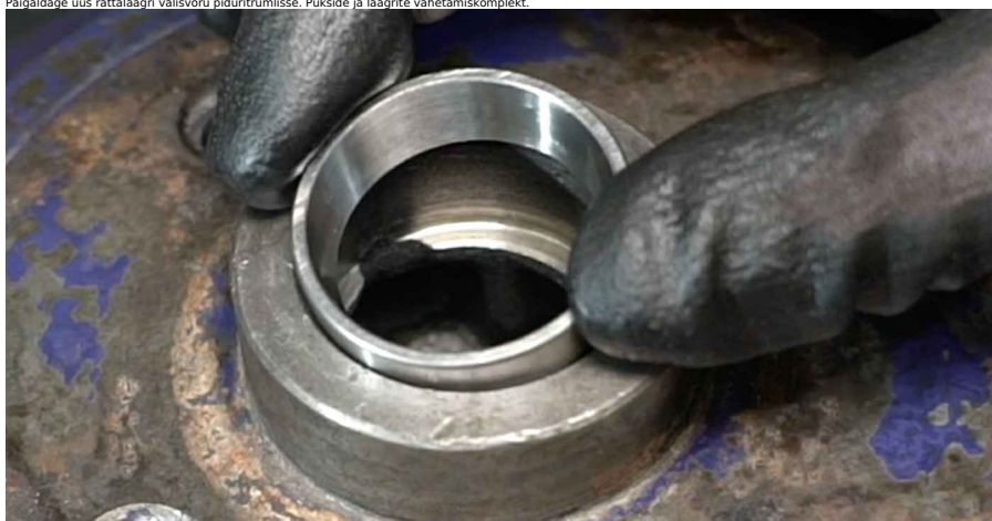
19 Paigutage rattarummu uue laagrivõru piduritrumlisse. Pukse ja laagrite vahetamiskomplekt.
