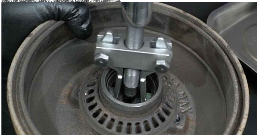
club.autodoc.ee 6-14 16 Eemaldage rattalaagri välisvõru piduritrumlist. Kasutage pükside ja laagrite vahetamiskomplekt.
