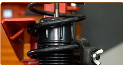
**32** Paigaldage ülemine vedrupüstak ja vedrupüstaku laager.
