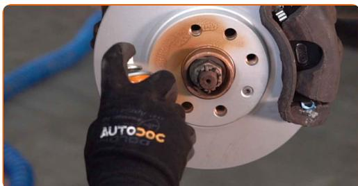
**34** Puhastage piduriketta pind. Kasutage piduri puhastusvahendit.
