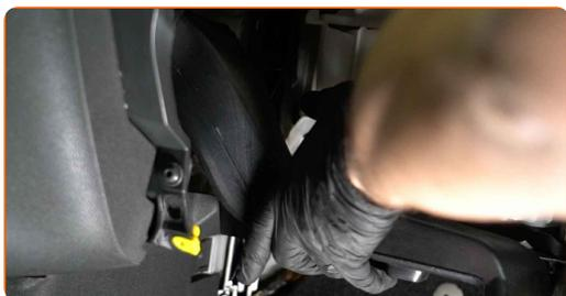
**17** Paigaldage õhukanali korpuse kinnitid.
