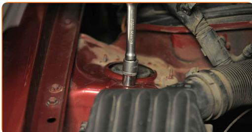
Vahetamine: vedru – VAUXHALL Corsa Mk I (B) Hatchback (S93). AUTODOC soovitab:
