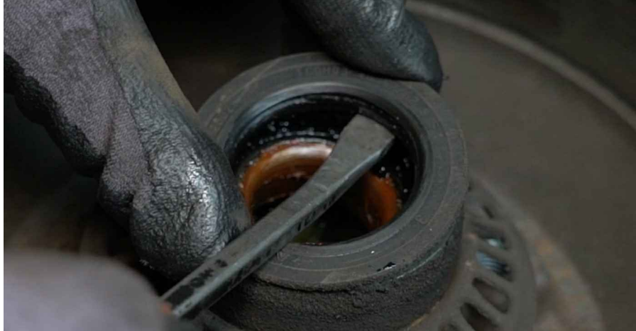
13 Eemaldage rummulaager. Kasutage sõrgkangi.
