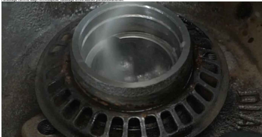
18 Paigaldage uus rattalaagri välisvõru piduritrumlisse. Pukse ja laagrite vahetamiskomplekt.
