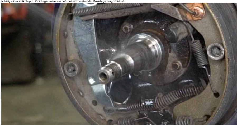
24 Paigaldage piduritrummel koos rattarummu laagriga.
