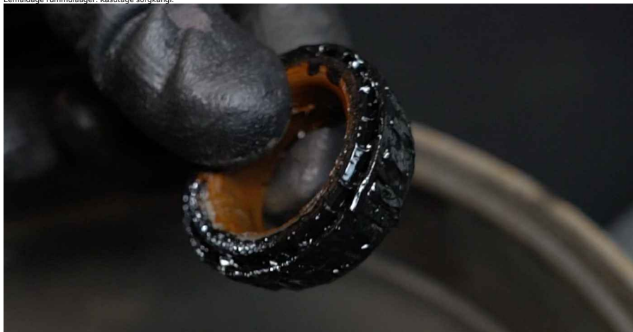
14 Puhastage rummu laagri kinnituspesa.
