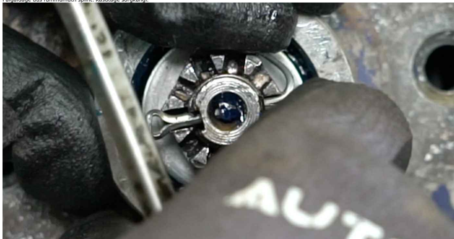
34 Paigaldage rummu mutrile kork. Kasutage kummihammit.
