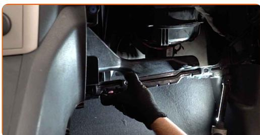
**18** Paigaldage õhukanali korpuse kinnitid.
