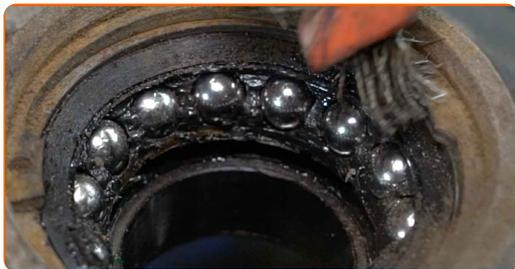
**44** Puhastage piduriketta katte kinnitused. Kasutage terasharja. Kasutage WD-40 aerosooli.
