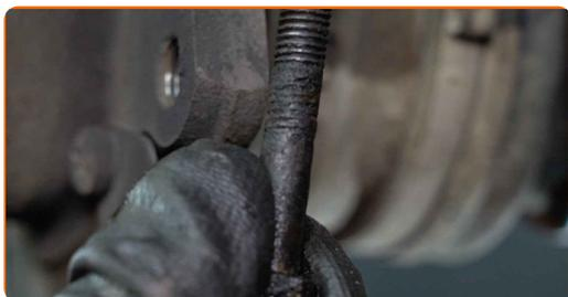
**30** Puhastage alumine kinnitus, mis ühendab vedrupüstmikku käänmikuga. Kasutage terasharja. Kasutage WD-40 aerosooli.
