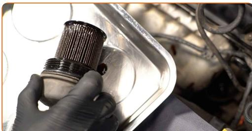
Vahetamine: mootoriõli ja filter – VAUXHALL Vectra Mk II (C) CC (Z02).
