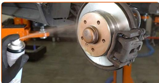
21 Puhastage piduriketta pind. Kasutage piduri puhastusvahendit.
