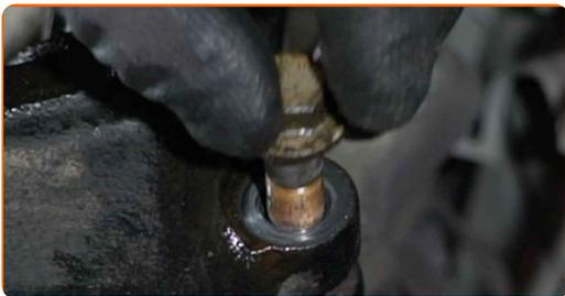
**36** Puhastage kinnitusdetail, mis ühendab kuulliigendit ja käändtelge. Kasutage terasharja. Kasutage WD-40 aerosooli.
