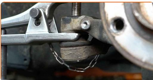
**33** Puhastage alumine kinnitus, mis ühendab vedrupüstmikku käänmikuga. Kasutage terasharja. Kasutage WD-40 aerosooli.
