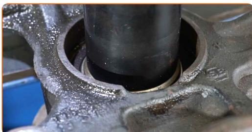
**51** Puhastage rummu laagri kinnituspesa. Kasutage terasharja. Kasutage WD-40 aerosooli.
