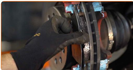
Vahetamine: piduriklotside – VW Beetle Hatchback (5C1, 5C2). Soovitus:
