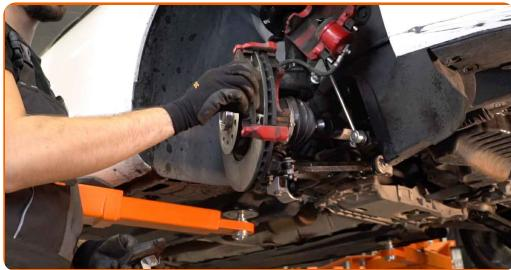
Vahetamine: piduriklotside – VW Beetle Hatchback (5C1, 5C2). AUTODOCi eksperdid soovitavad:
