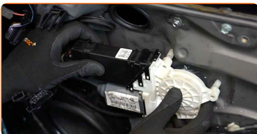
**40** Pingutage akende elektrimootori kinniteid. Kasutage tähikvõtit T30. Kasutage momentvõtit. Pingutage seda 4 Nm pöördemomendiga.
