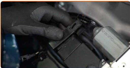
**39** Paigaldage aknatõstuki mootor.
