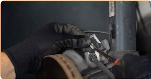
16 Puhastage kinnitused, mis ühendavad stabilisaatorilinke vedrupüstakutega ja need, mis ühendavad vedrupüstakuid käändteljega. Kasutage terasharja. Kasutage WD-40 aerosooli.
