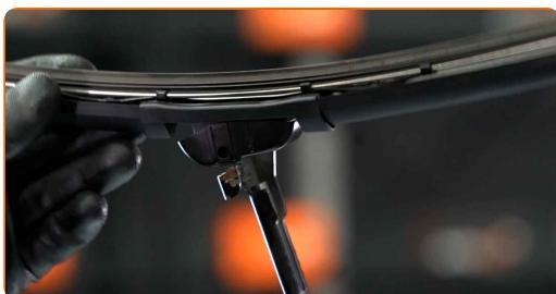
Vahetamine: klaasipuhastite – VW Caddy III Van (2KA, 2KH, 2CA, 2CH).
