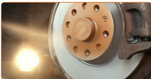
**24** Puhastage piduriketta pind. Kasutage piduri puhastusvahendit.
