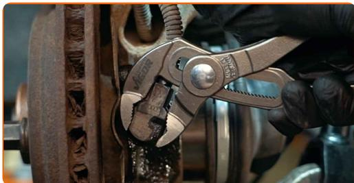
**11** Puhastage ABS-anduri paigalduspesa. Kasutage terasharja. Kasutage WD-40 aerosooli. Kasutage piduri puhastusvahendit.
