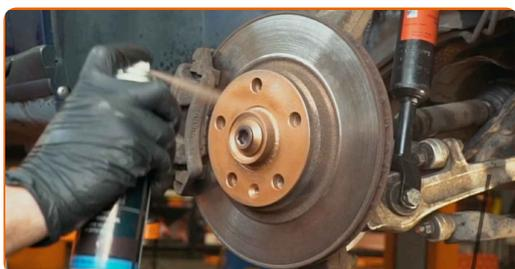
**23** Puhastage piduriketta pind. Kasutage piduri puhastusvahendit.
