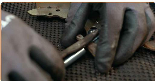
**22** Paigaldage uute piduriklotside ülemine säilitusvedru ja kohandusmehhanism. Kasutage lapiku otsaga kruvikeerajat.
