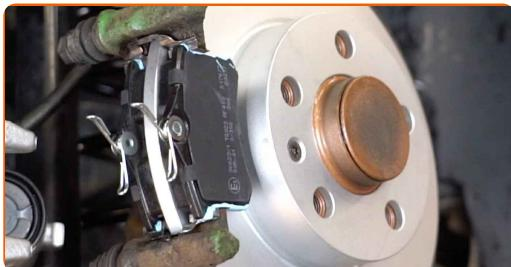
Vahetamine: piduriklotside – VW Passat B2 Variant (33B). AUTODOC soovitab:
