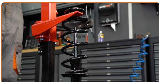
41 Paigaldage tolmutate ja uue amortisaatori stopper.
