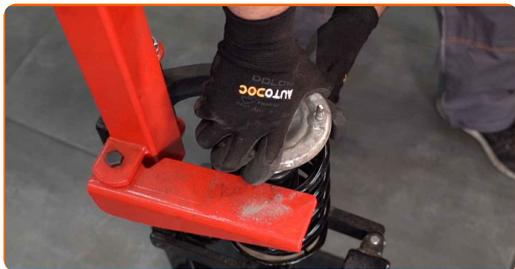
42 Paigaldage ülemine vedrupüstak ja vedrupüstaku laager.
