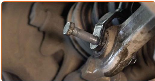
23 Eemaldage alumine amordipüstaku osa. Kasutage sõrgkangi.
