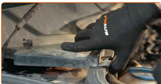
**78** Paigaldage plastikust tuuleklaasi õhutusvõre kininitused.
