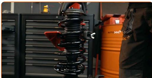
**42** Paigaldage ülemine vedrupüstak ja vedrupüstaku laager.
