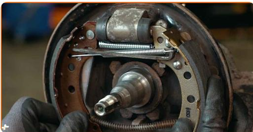
**26** Paigaldage trummelpidurite klotside hoidikud. Kasutage piduriklotsi paigalhoidvat vedrukompessorit.
