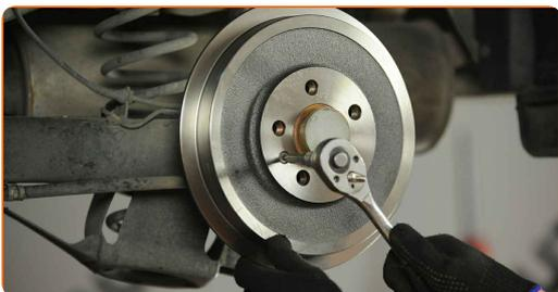
**12** Töödelge pindasid, kus velg puutub piduritrumliga kokku. Kasutage kõrgtemperatuure taluvat keraamilist määret.
