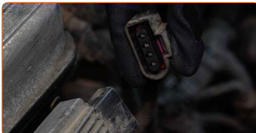
**4** Puhastage süütepoolide poldid. Kasutage terasharja. Kasutage WD-40 aerosooli.
