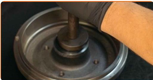
**25** Paigaldage uus rummu laager ja kinnitage see.
