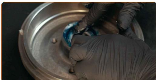
**24** Suruge rattalaagri sisemine õlitihend sisse. Kasutage pukside ja laagrite vahetamiskomplekt. Kasutage haamrit.
