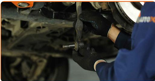
**13** Puhastage roolilati otsade paigalduspesad. Kasutage terasharja. Kasutage WD-40 aerosooli.
