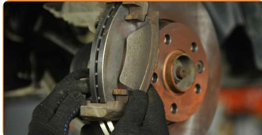
Vahetamine: piduriklotside – VW Transporter V Buss (7HB, 7HJ, 7EB, 7EJ, 7EF, 7EG, 7HF, 7EC). Professionaalid soovitavad:
