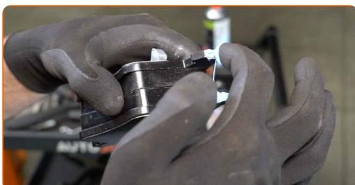
Vahetamine: piduriklotside – VW Transporter V Buss (7HB, 7HJ, 7EB, 7EJ, 7EF, 7EG, 7HF, 7EC). AUTODOC'i eksperdid soovitavad:
