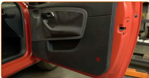
2 Eemaldage ukse käetoe paneel. Kasutage plastikust eemaldajat.
