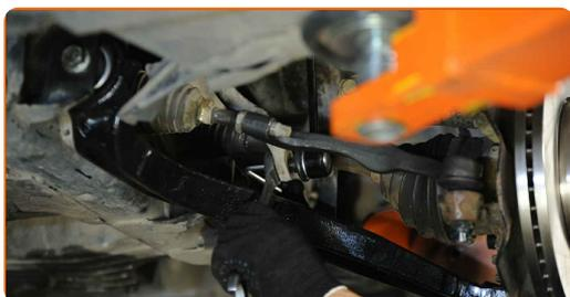
**13** Pingutage kinnitust, mis ühendab stabilisaatorilülid amordipüstakuga. Kasutage padrunit Nr.19. Kasutage momentvõtit. Pingutage seda 60 Nm pöördemomendiga.+45°
