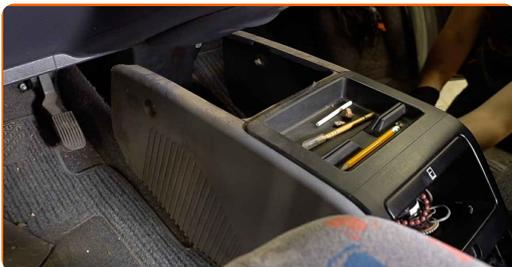
4 Keerake lahti ja eemaldage latt, mis kinnitab keskkonsooli alumist osa. Kasutage padrunit Nr.10. Kasutage kärstivõtit.
