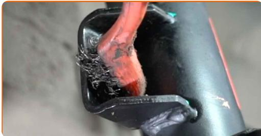
**11** Paigaldage uus põikstabilisaator ja pingutage kinniteid.
