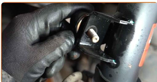
**12** Pingutage kinnitust, mis ühendab stabilisaatorilüli stabilisaatorvarbiga. Kasutage padrunit Nr.14. Kasutage momentvõtit. Pingutage seda 47 Nm pöördemomendiga.
