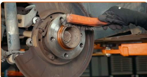
21 Eemaldage korrosioonivastane määre uuel pidurikettalt. Kasutage piduri puhastusvahendit.
