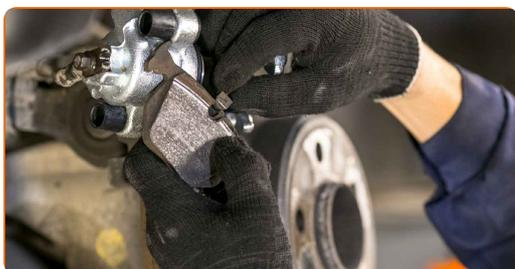
**27** Paigaldage piduriklotsid.
