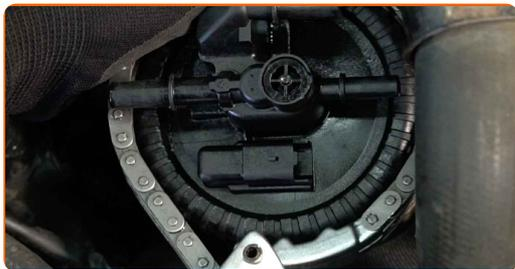
**9** Eemaldage kütusefilter. Pange vana õlifiltri kassett konteinerisse.
