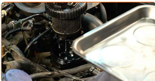
**10** Eemaldage vana filterkassett filtri korpusest. Kasutage sõrgkangi.
